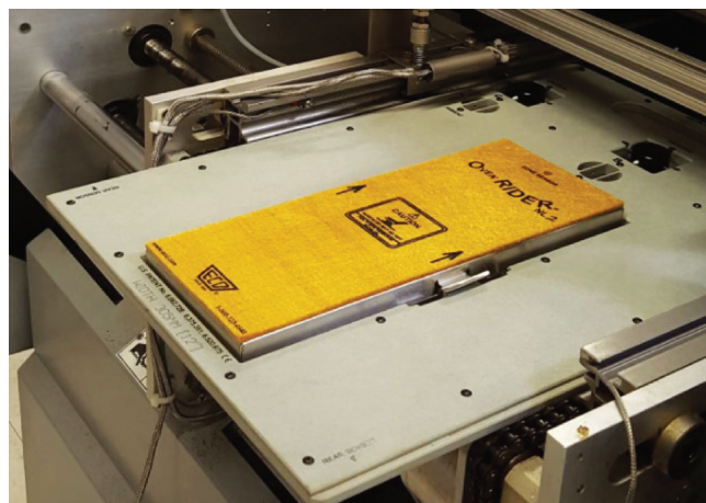
Obr. 2 Profilování pece pomocí procesní palety
